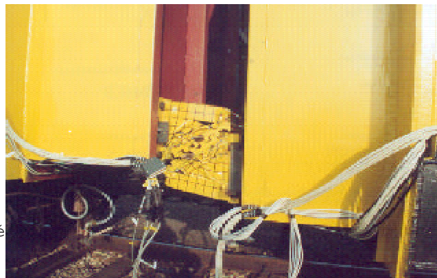
při zkoušce se nárazníky zničí
